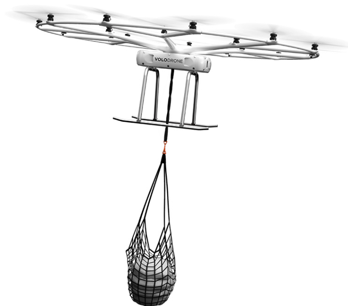
Slika 15. VoloDrone za prijevoz manjeg tereta ( https://www.volocopter.com/solutions/volodrone/ )
