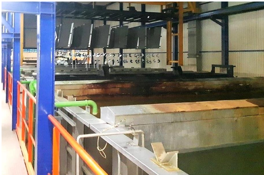
Slika 17. Linija za postupak kataforeze (Izvor: Dugonjić, 2021.)
