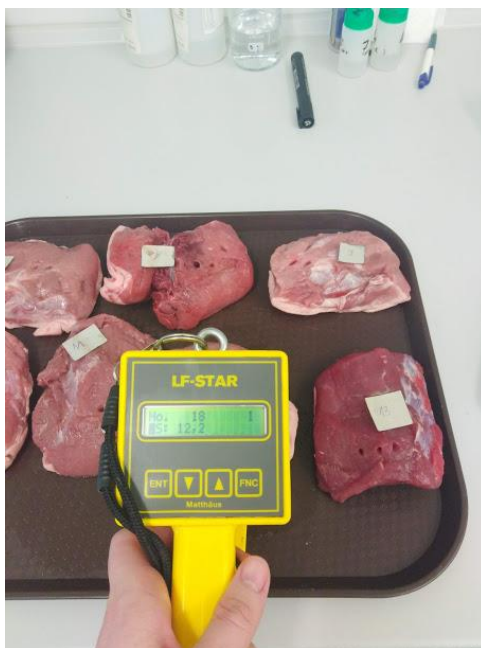
Slika 5. Mjerenje električne provodljivosti LF Star uređajem
