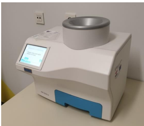
Slika 18. Uređaj za mjerenje hektolitarske mase
