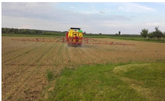
Slika 16. Primjena herbicida traktorskom prskalicom
