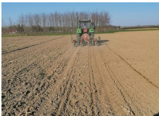
Slika 9. Sjetva pneumatskom sijačicom
