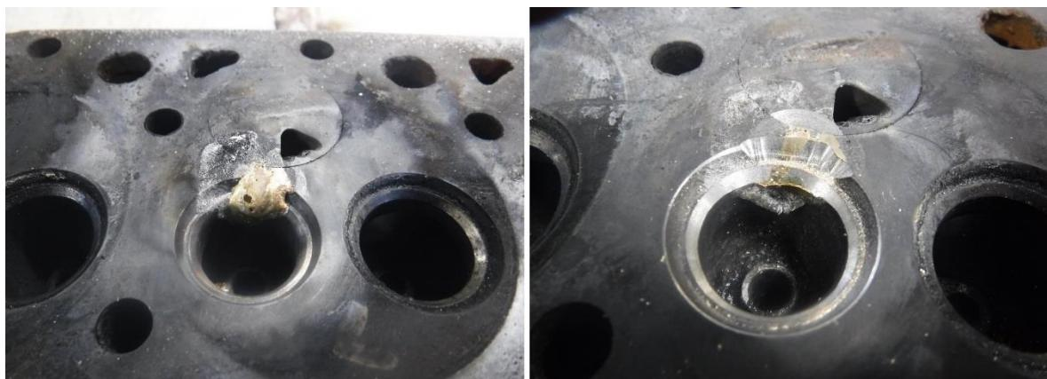
Slika 21. Reparaturno zavarivanje glave motora traktora
