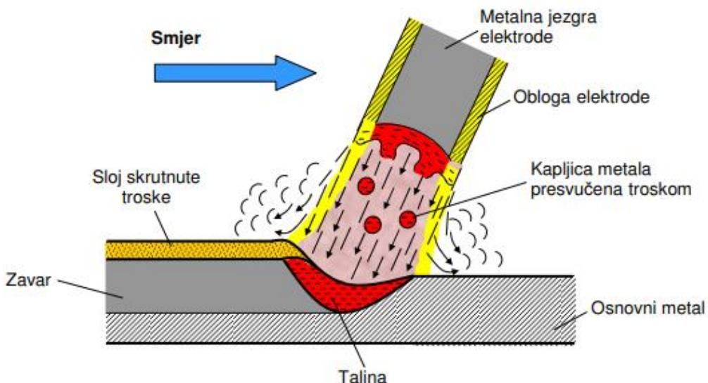
Slika 15. Shema elektrolučnog zavarivanja obloženom elektrodom
