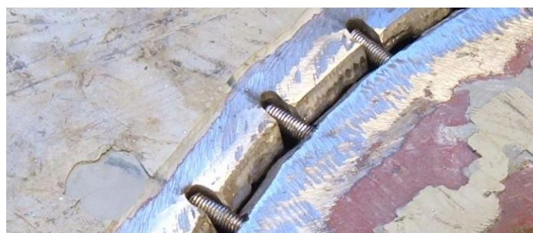
Slika 20. Primjer ugradnje uvrtnih vijaka u spojne površine odljevka
