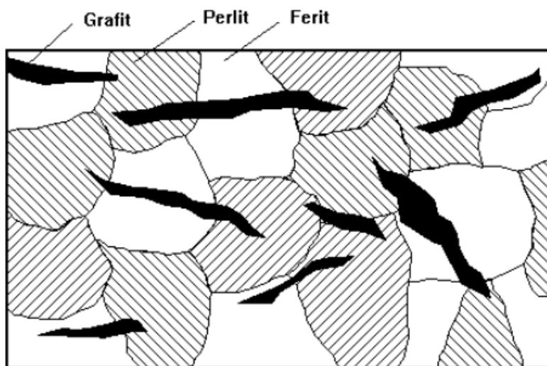
Slika 3: Shematski prikaz strukture feritno-perlitne mikrostrukture
