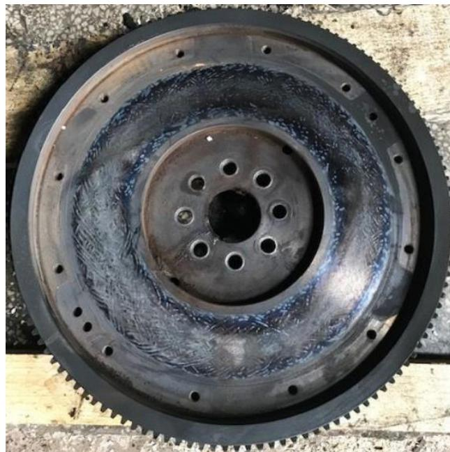
Slika 9: Zamašnjak traktora
