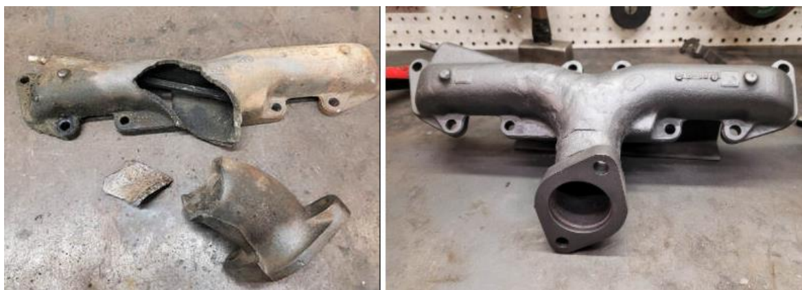
Slika 22. prikazuje primjer reparaturnog zavarivanja razvodne grane ispuha traktora
