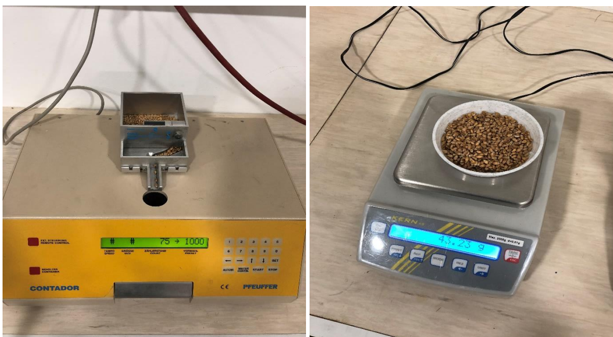
Slika 10. Mjerenje mase 1000 zrna (izvor: Pavkić M.)
