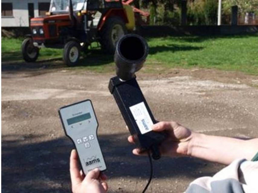
Slika 12. AAMS uređaj za mjerenje protoka mlaznice
