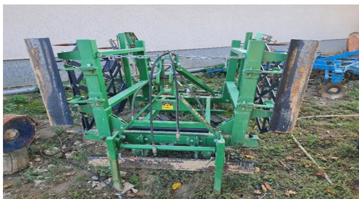
Slika 18. Laka drljača Pecka - priprema tla za sjetvu
