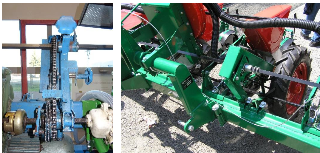
Slika 9. Mjenjačka kutija (lijevo) i pogon od voznog kotača ( z=32 ) prema gornjem vratilu ( z=24 ) lančanim prijenosom (desno)
