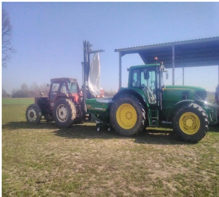
Slika 5. Traktor Fiat agregatiran viličarom i traktor John Deere agregatiran rasipačem Donder 1500 l u prihrani pšenice (Izvor: Hrvoje Čolaković)
