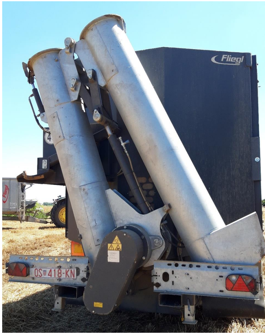
Slika 41. Transportni položaj pužnog transportera prikolice Fliegl Gigant ASW 271
