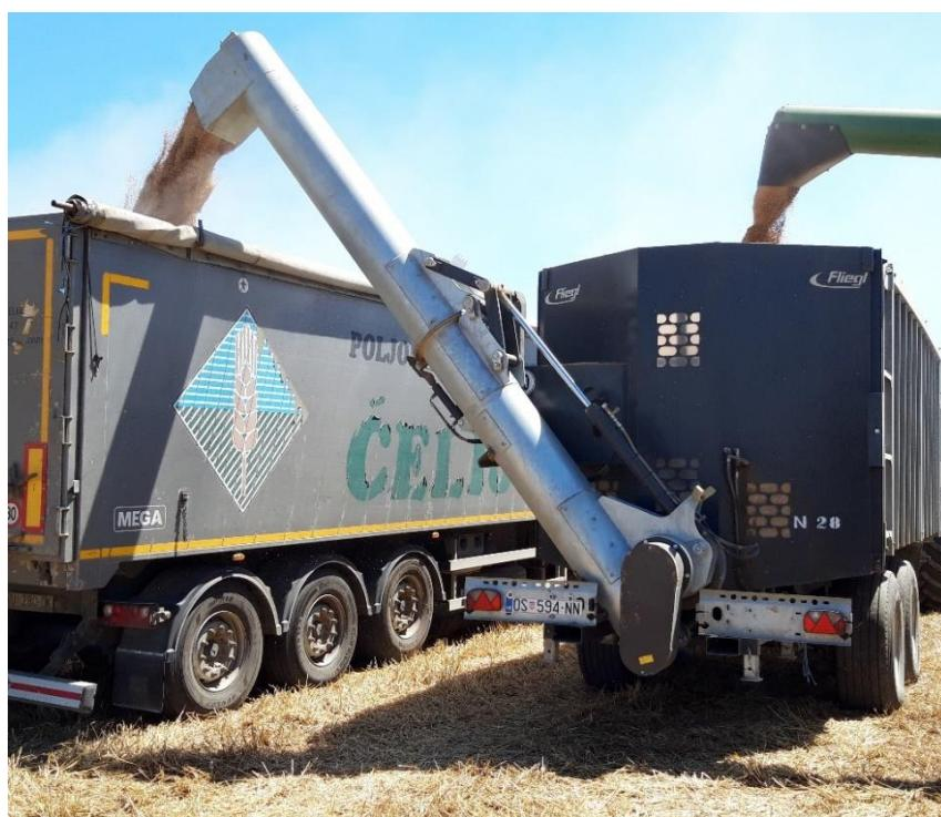
Slika 39. Radni položaj pužnog transporterera na prikolici *Fliegl Gigant ASW 271*
