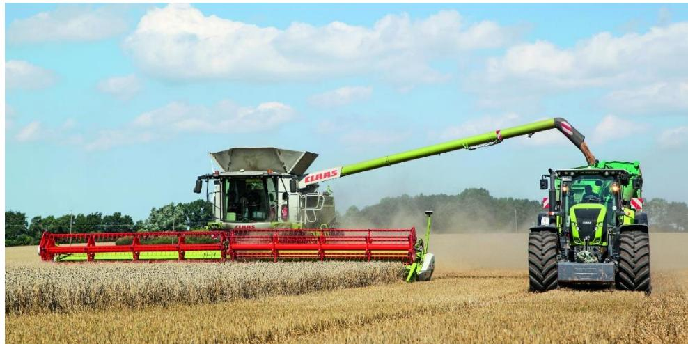
Slika 16. Cijev za pražnjenje u radnom položaju
