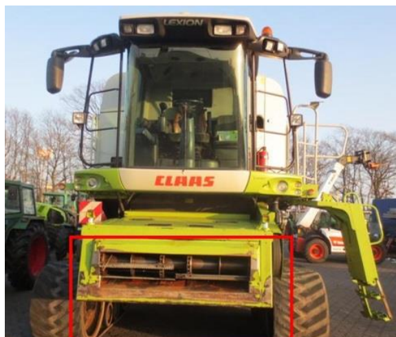
Slika 7. Elevator žitne mase univerzalnog žitnog kombajna Claas Lexion 560
