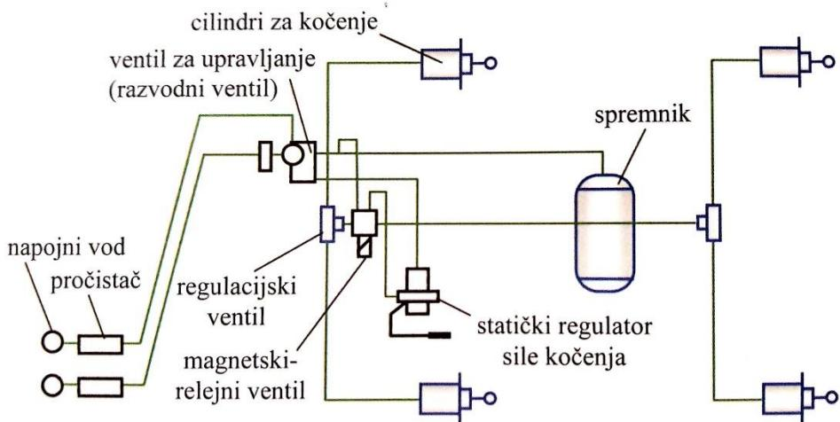
Slika 36. Dijelovi dvovodnog pneumatskog sustava za kočenje
