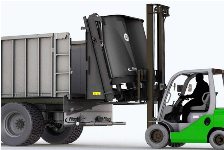
Slika 30. Zamjena zadnje stranice pomoću malog viličara
