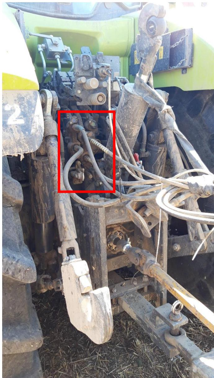
Slika 34. Pneumatske instalacije na traktoru *Claas Axion 960*
