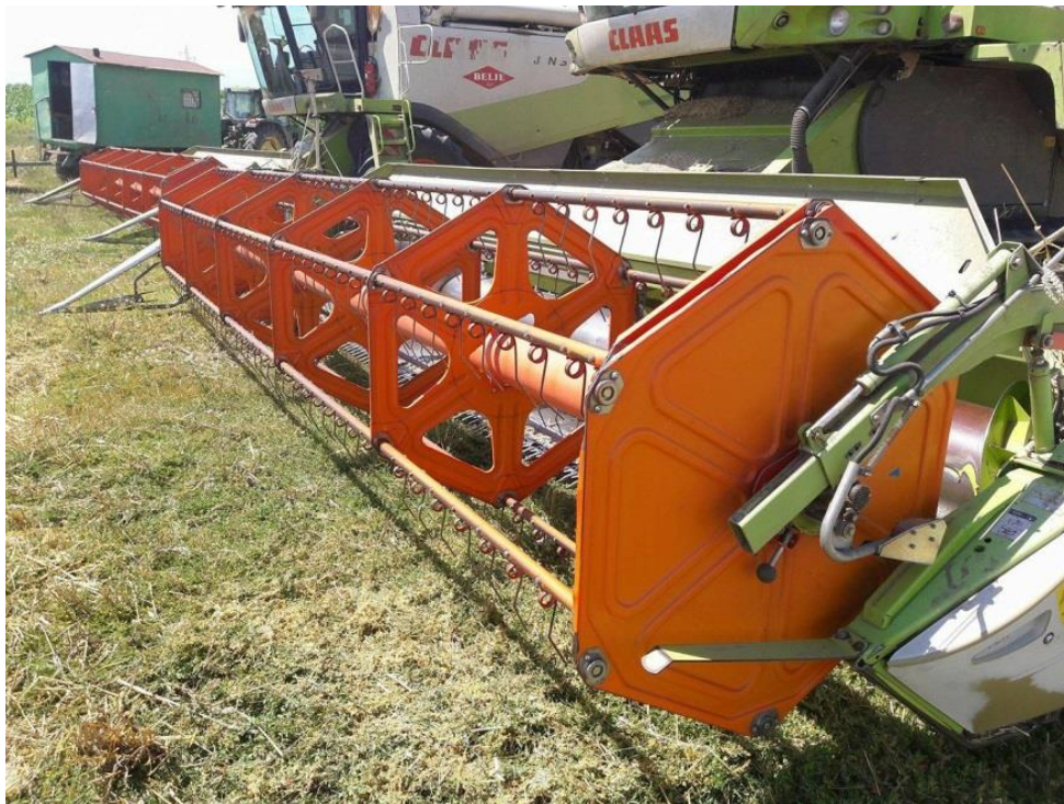
Slika 6. Motovilo na hederu Claas V 660
