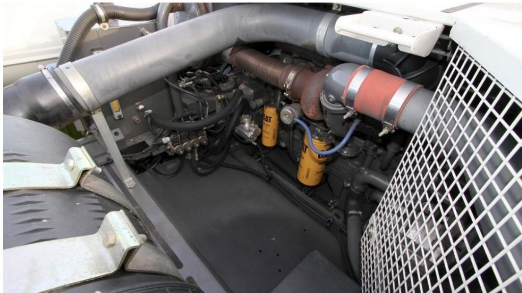
Slika 17. Motor *CAT C10* kombajna *Claas Lexion 560*
