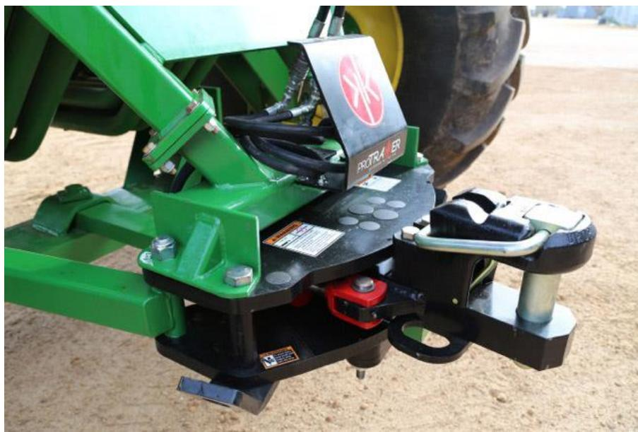
Slika 55. *ProTrakker* priključak priključna poteznica za upravljanje priključkom
