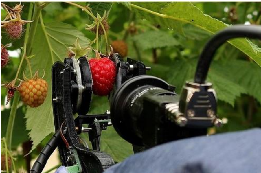
Slika 30. Meki manipulator za branje malina
