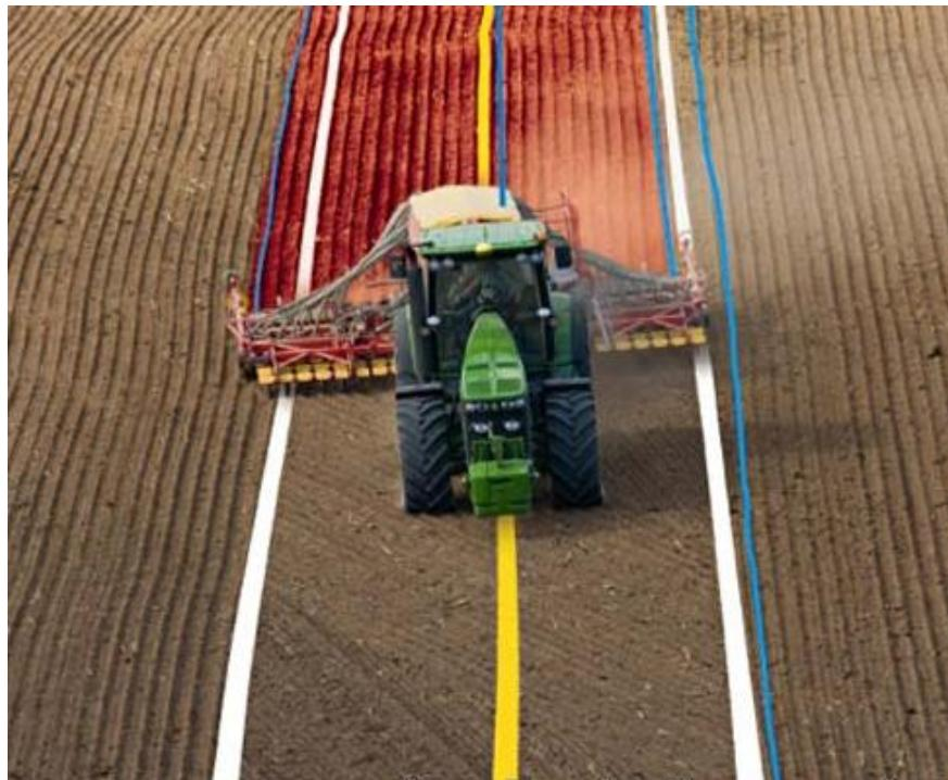
Slika 53. Poravnavanje pravca kretanja traktora i priključka pomoću sustava *iGuide* i *iSteer*
