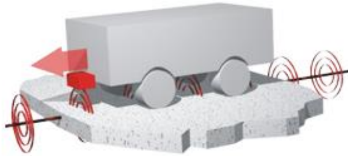
Slika 7. Žični sustav navođenja
