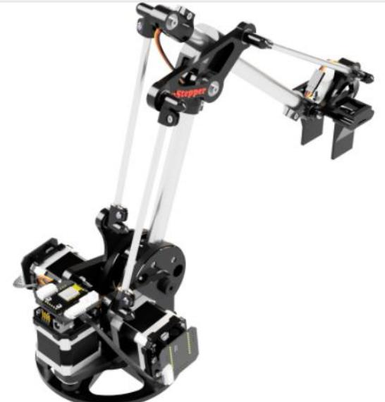
Slika 25. Robotska ruka pogonjena sa koračnim motorima
