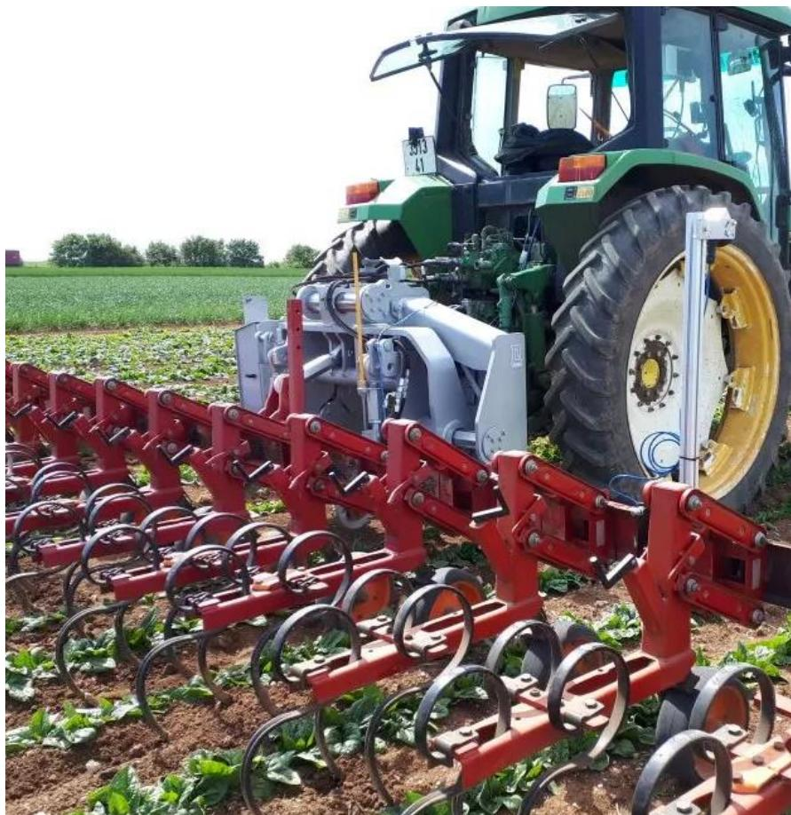
Slika 56. *Dynatrac* poteznica sa kamerom za reduciranje zanošenja priključka
