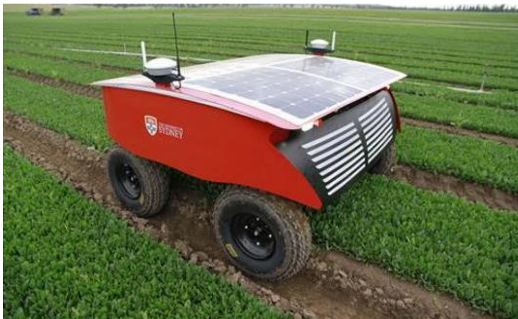
Slika 63. Rippa robot, kemijsko suzbijanje korova (Izvor: https://robot.cfp.co.ir/en/newsdetail/335 )
