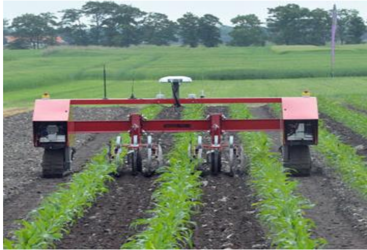
Slika 64. Vibro Crop Robotti, robot za mehaničko suzbijanje korova
