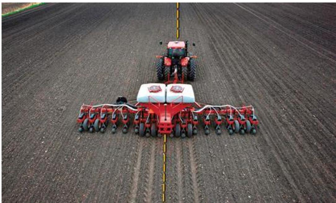
Slika 54. *TrueGuide* pasivno reducirane zanošenja priključka, proizvođač *Case*
