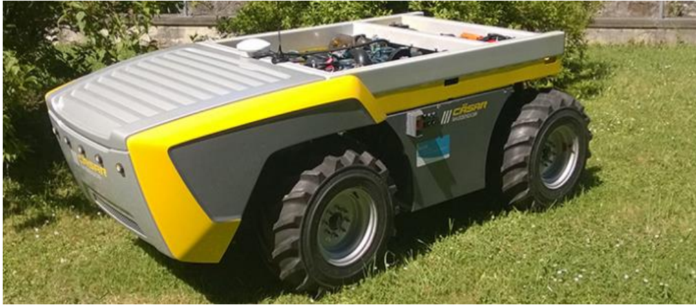
Slika 62. Cäsar, robot koji obavlja opće poslove u voćnjaku i vinogradu (Izvor: https://www.raussendorf.de/en/fruit-robot.html )
