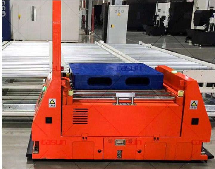
Slika 3. AGV teretna paluba opremljena valjcima
