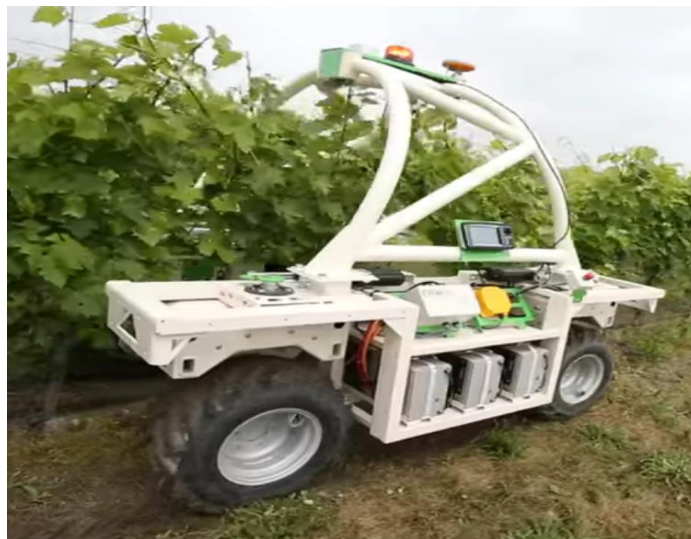
Slika 65. Naïo robot, prorjeđivanje lišća u vinogradu
