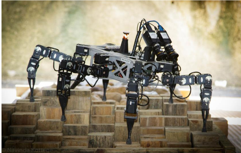
Slika 23. Složeni mehanizam kretanja za savladavanje teških terena
