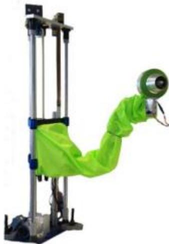
Slika 31. Redundantna robotska ruka sa raspršivačem
