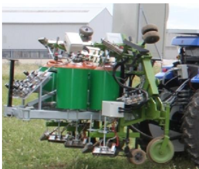
Slika 52. Priključak za termičko suzbijanje korova upravljjan PLC – om
