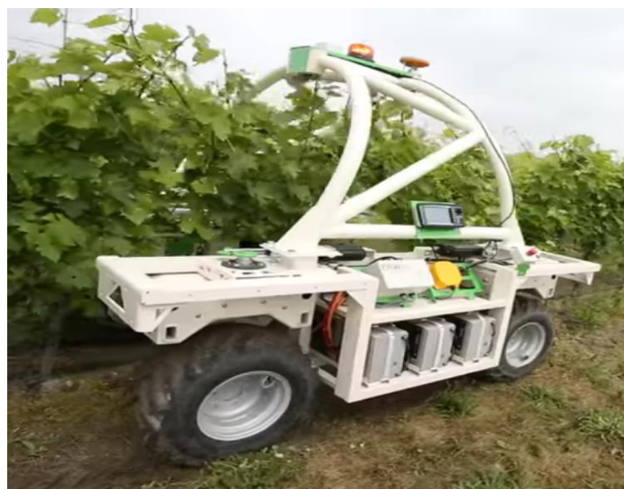
Slika 65. Naïo robot, prorjeđivanje lišća u vinogradu
