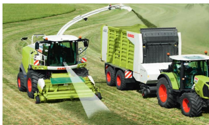
Slika 40. CAM PILOT Claas 3D sustav kamera
