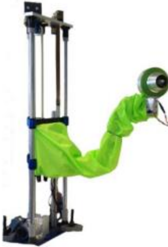
Slika 31. Redundantna robotska ruka sa raspršivačem (Izvor: Bontsema i sur., 2014.)
