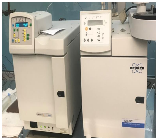
Slika 41. Uređaj za analizu kemijskog sastava bioplina (Izvor. vlastita fotografija, 2017.)
