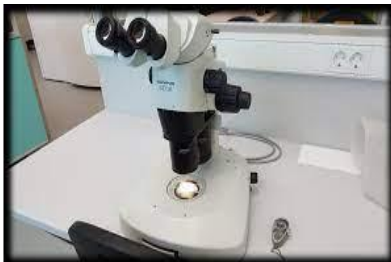
Slika 15. Svjetlosna lupa pomoću koje su prebrojane nematode
