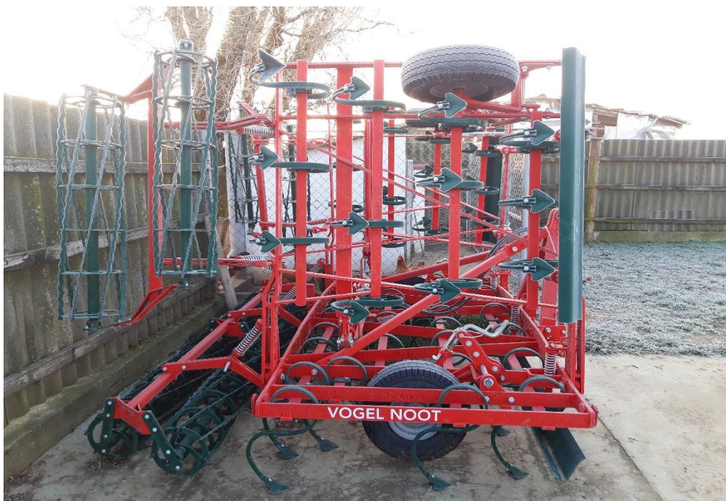
Slika 15. Sjetvospremač za pripremu i sječu korova
