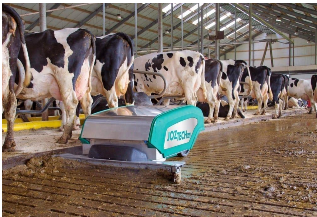
Slika 9. Robot u fazi čišćenja blatnog hodnika u staji firme JOZ BV
