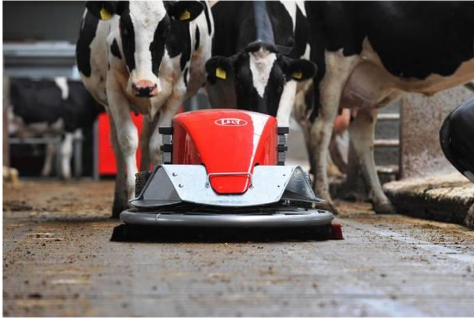
Slika 7. Samohodni robot za čišćenje blatnih hodnika u staji firme Lely
