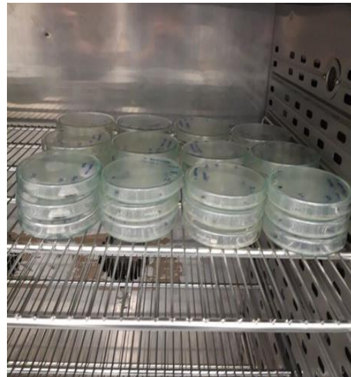
Slika 6. Postavljanje Petrijevih zdjelica u termostat komoru
