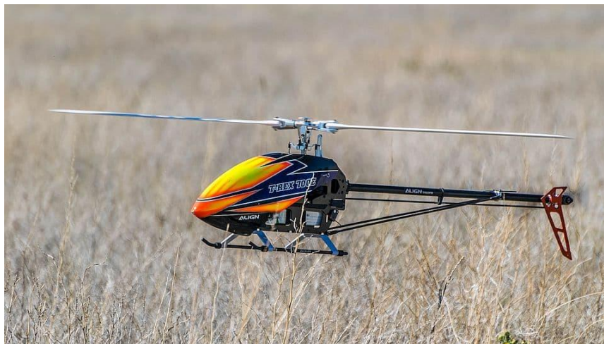
Slika 6. Bespilotni zrakoplov s jednim rotorom pogonjen elektromotorom
