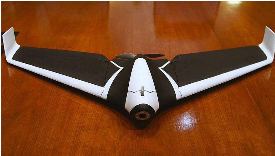
Slika 5. Bespilotni zrakoplov sa fiksnim krilima
