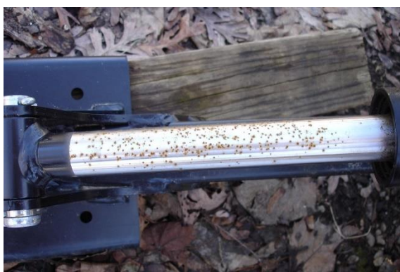
Slika 23. Hidraulički cilindar zahvaćen korozijom
