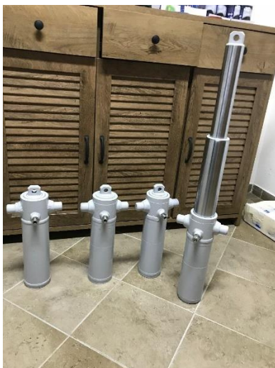
Slika 22. Teleskopski cilindar za prikolicu „Zmaj – 8t“
