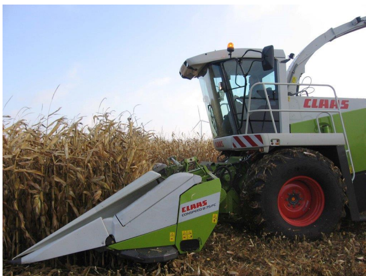
Slika 10. Heder (čeonik) silo kombajna u radnom položaju
