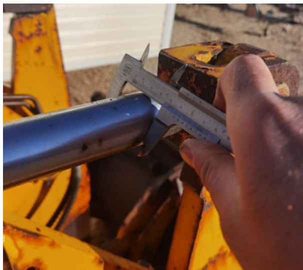
Slika 35. Rupičasta „pitting“ korozija na klipnjači hidrauličkog cilindra
