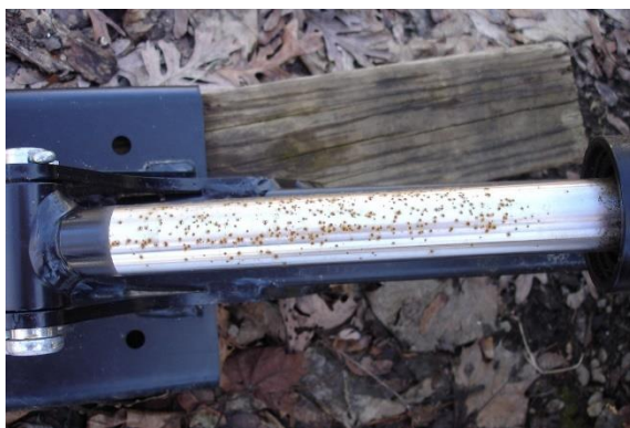
Slika 23. Hidraulički cilindar zahvaćen korozijom
