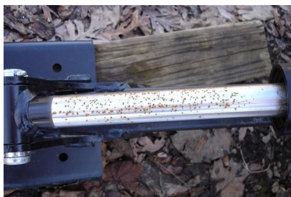
Slika 23. Hidraulički cilindar zahvaćen korozijom
