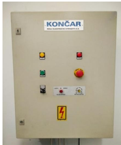
Slika 16. Upravljački dio uređaja za trošenje u masi abraziva (Izvor: Vidaković, 2021.)
