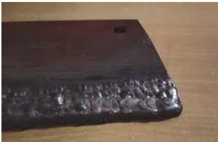
Slika 8. Navarivanje tvrdog materijala na lemeš pluga (Izvor: Dtzsb.unisb.hr)
