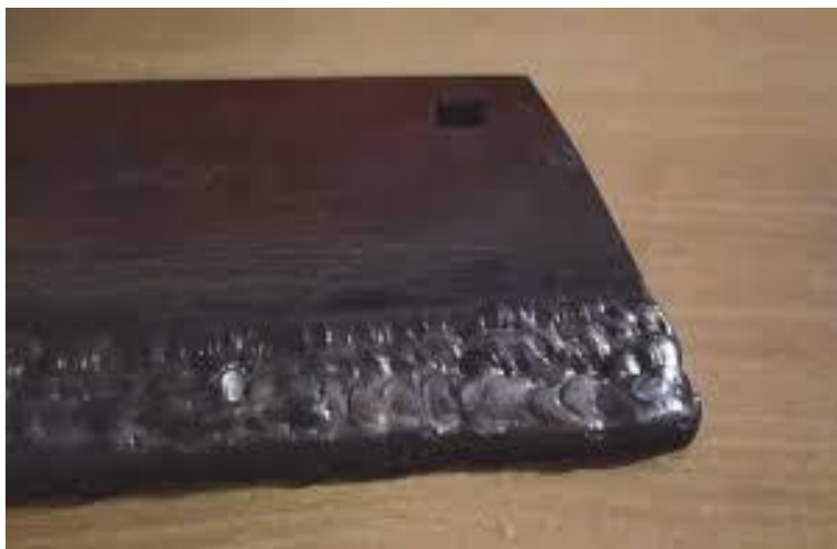
Slika 8. Navarivanje tvrdog materijala na lemeš pluga (Izvor: Dtzsb.unisb.hr)
