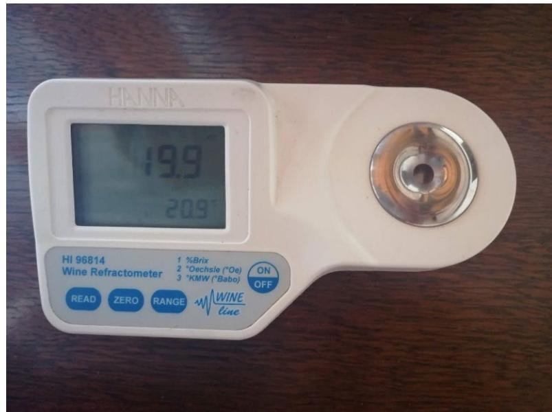
Slika 6. Digitalni refraktometar
