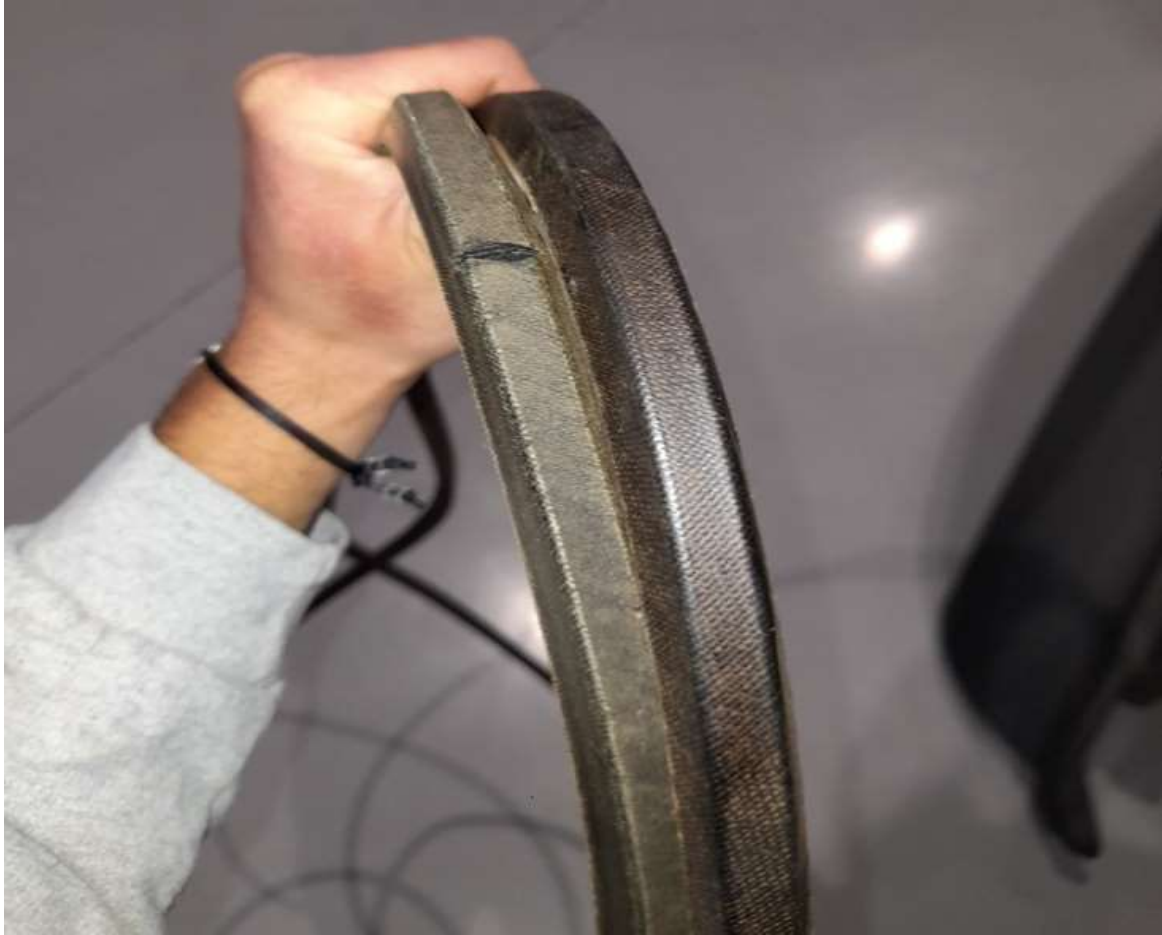
Slika 15. Prikazuje usporedbu novog i istrošenog remena za pogon (Izvor: Vlastita fotografija)
