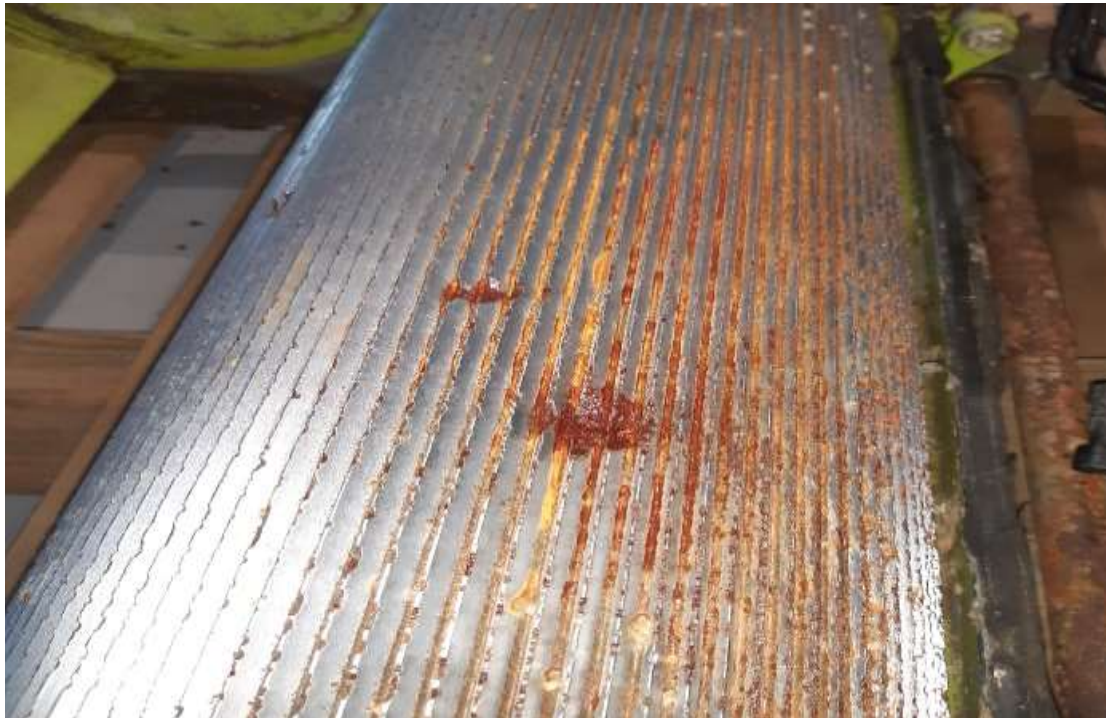
Slika 10. Prikazuje istrošene dijelove Corn crackera (Izvor: Vlastita fotografija)
