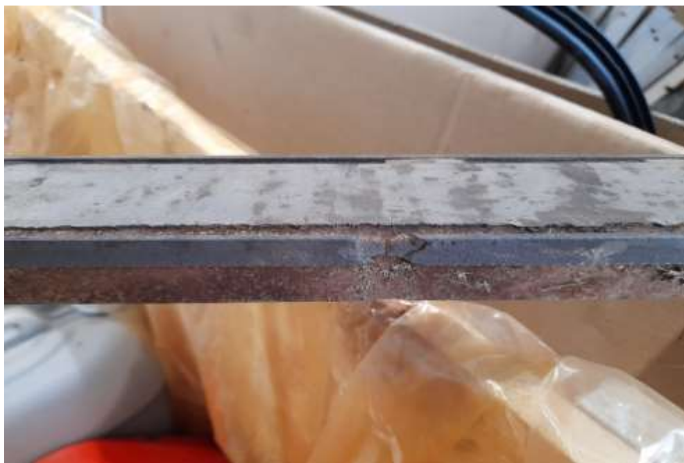
Slika 20. Prikazuje vidljive znakove trošenja kontranoža (Izvor: Vlastita fotografija)
