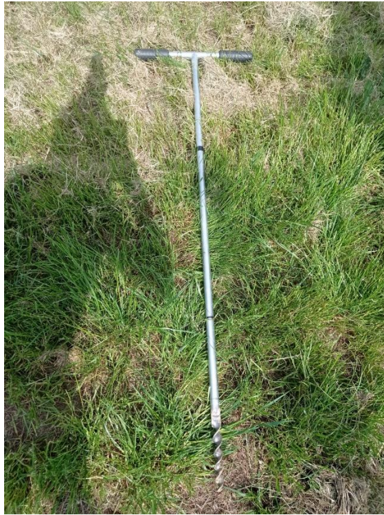
Slika 18. Svrđlo za postavljanje senzora u tlo
