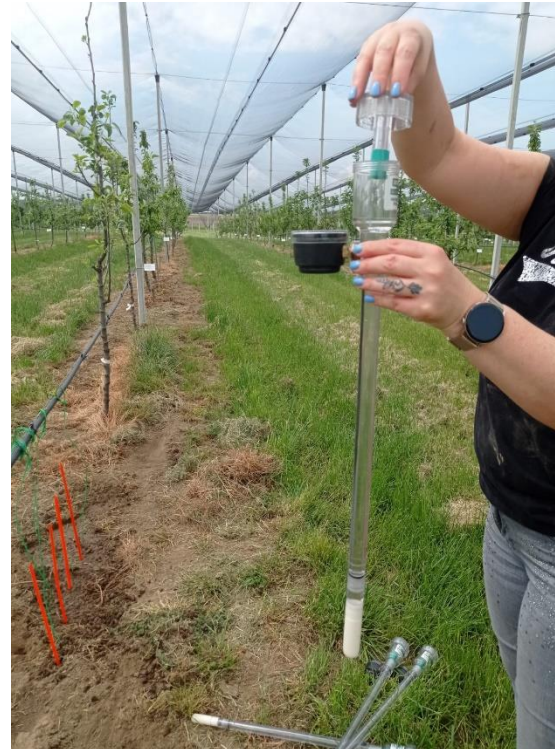
Slika 19. Punjenje senzora destiliranom vodom
