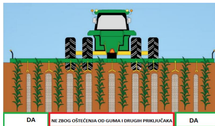
Slika 14. Prikaz prikladnog mjesta za postavljanje senzora
