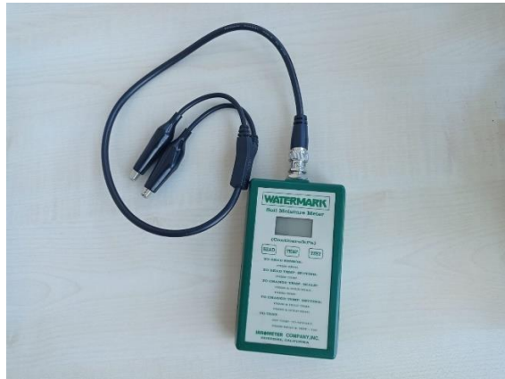
Slika 11. Watermark uređaj za mjerenje vlage tla
