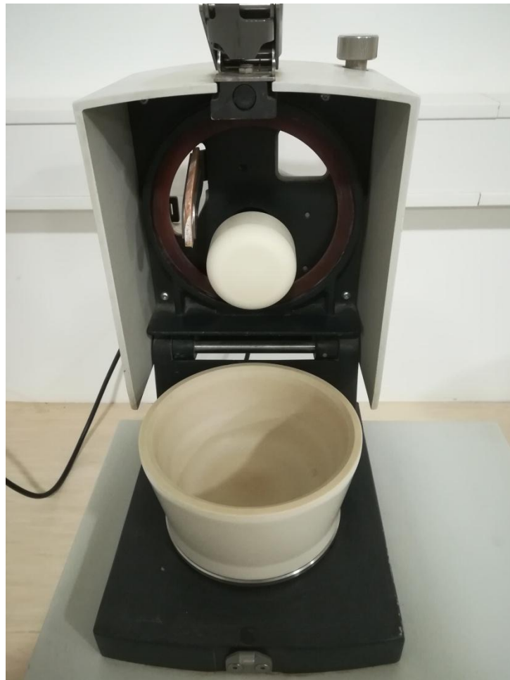
Slika 6. Mlin za mljevenje uzorka ječma (Izvor: autor)
