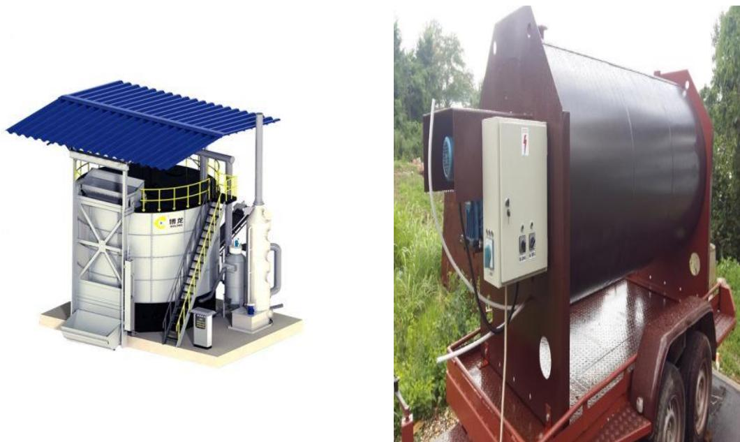
Slika 6. Vertikalni i horizontalni reaktor
