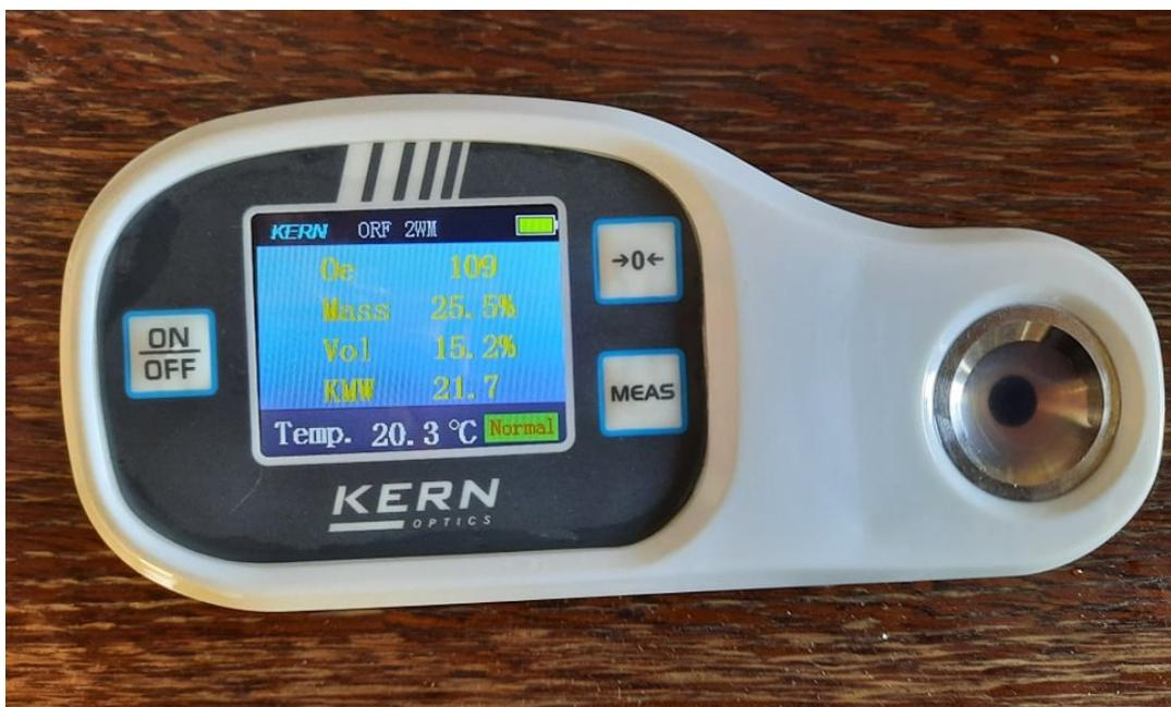
Slika 8. Digitalni refraktometar
