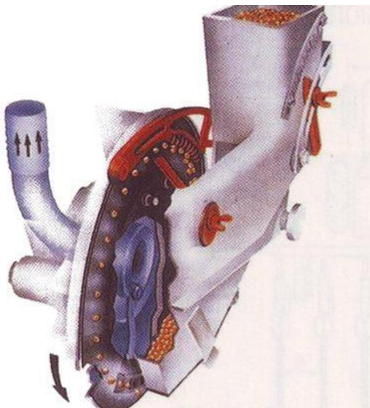
Slika 9. Sjetveni aparat PSK4 sijačice
