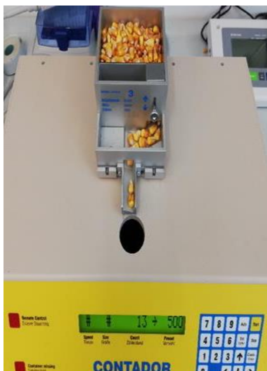
Slika 6. Brojanja zrna pomoću uređaja (izvor: Bižić, T.)
