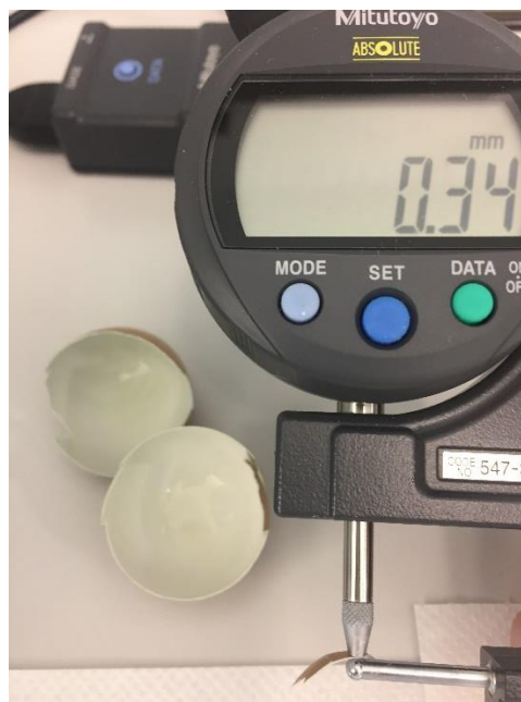
Slika 20. Mjerenje debljine ljuske jaja (foto: Fazanerija Božur)
