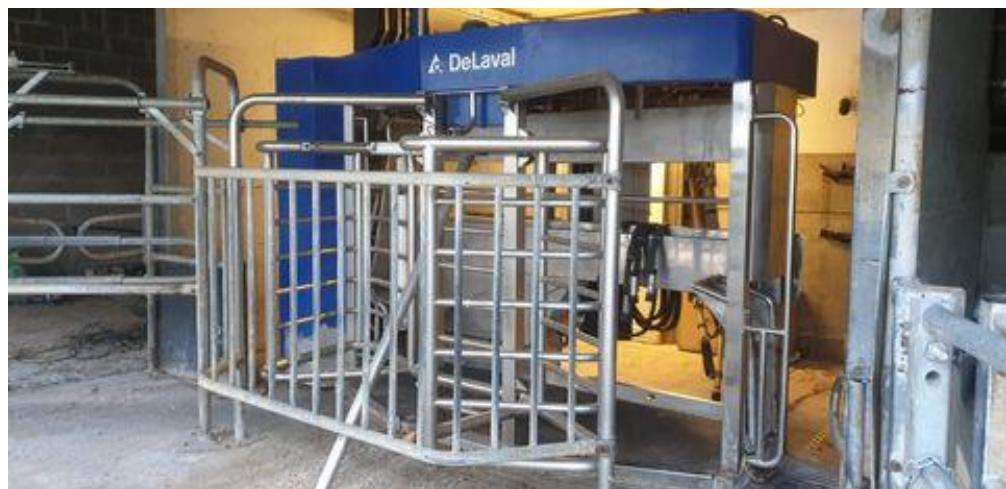
Slika 6: Robot za mužnju (DeLaval) (Izvor: Landwirt.com)
