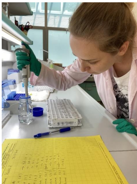
Slika 22. Pipetiranje 0,2 mM natrij acetata u 76% etanolu (foto original: J. Kovač)
