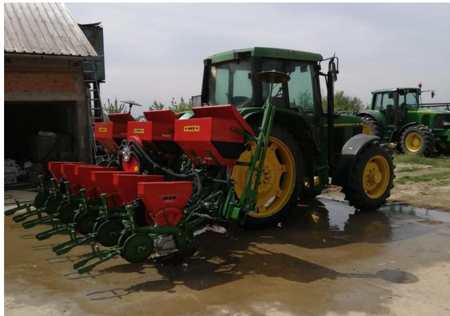
Slika 12. Pneumatska sijačica OLT PSK 6
