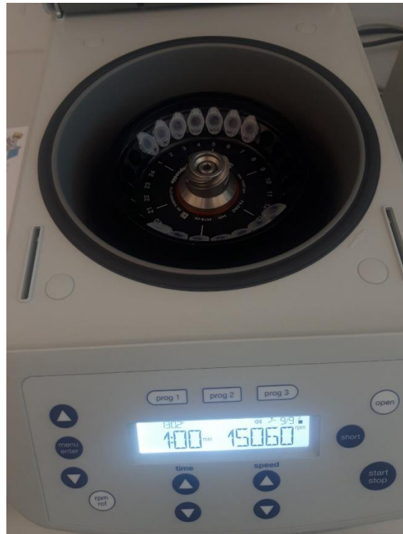
Slika 9. Centrifugiranje uzoraka u zadnjem koraku izolacije (foto original; F.Tomić)
