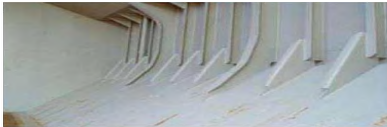
Slika 13. Skladište broda za transport rasutih tereta – žitarica Izvor: (Ćorić, 2018.)
