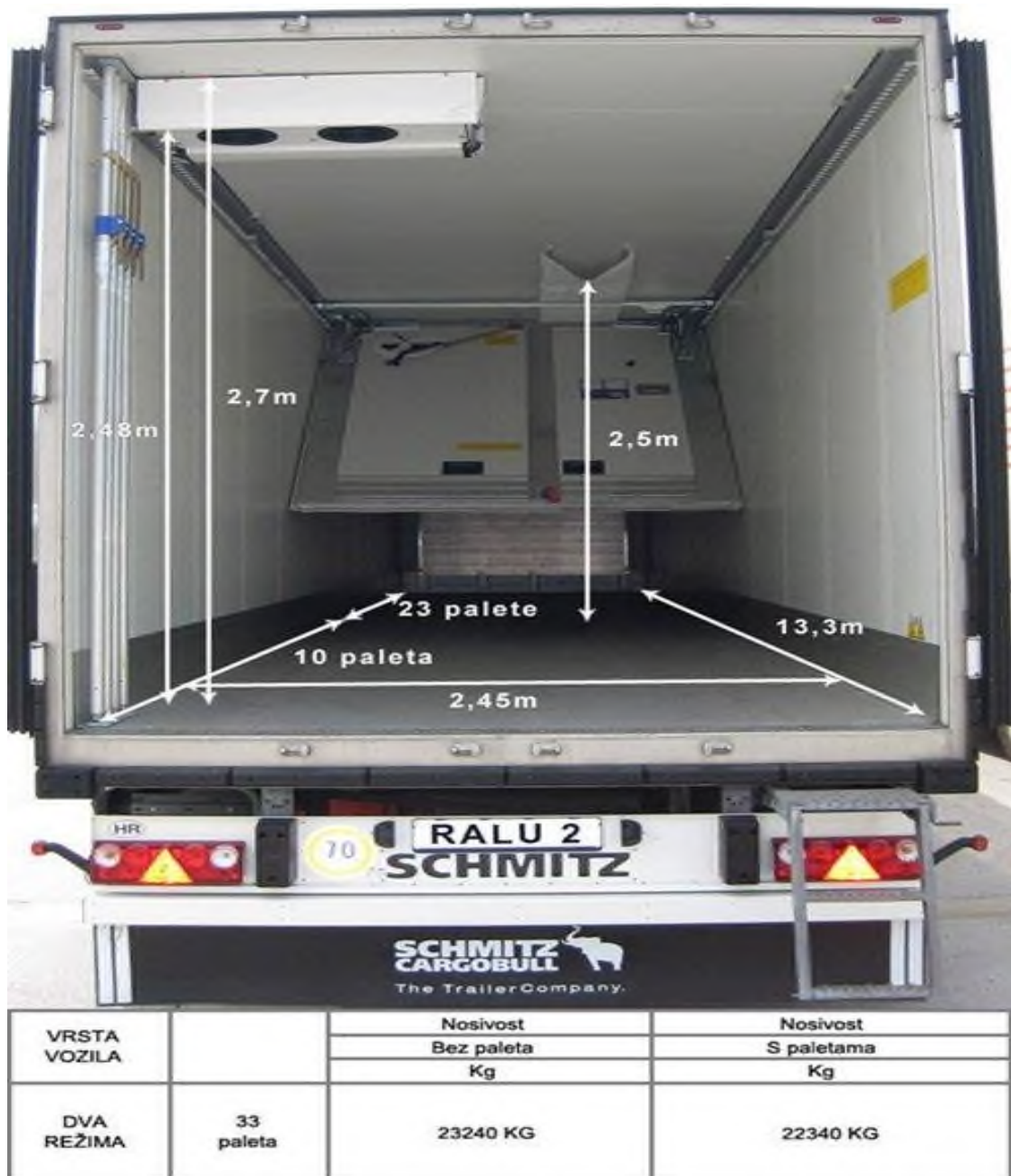
Slika 11. Kamion s rashladnim uređajem – dvorežimski za prijevoz robe na različitim temperaturama
