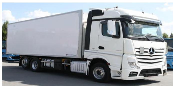
Slika 10. Kamion s rashladnim uređajem (hladnjača)
