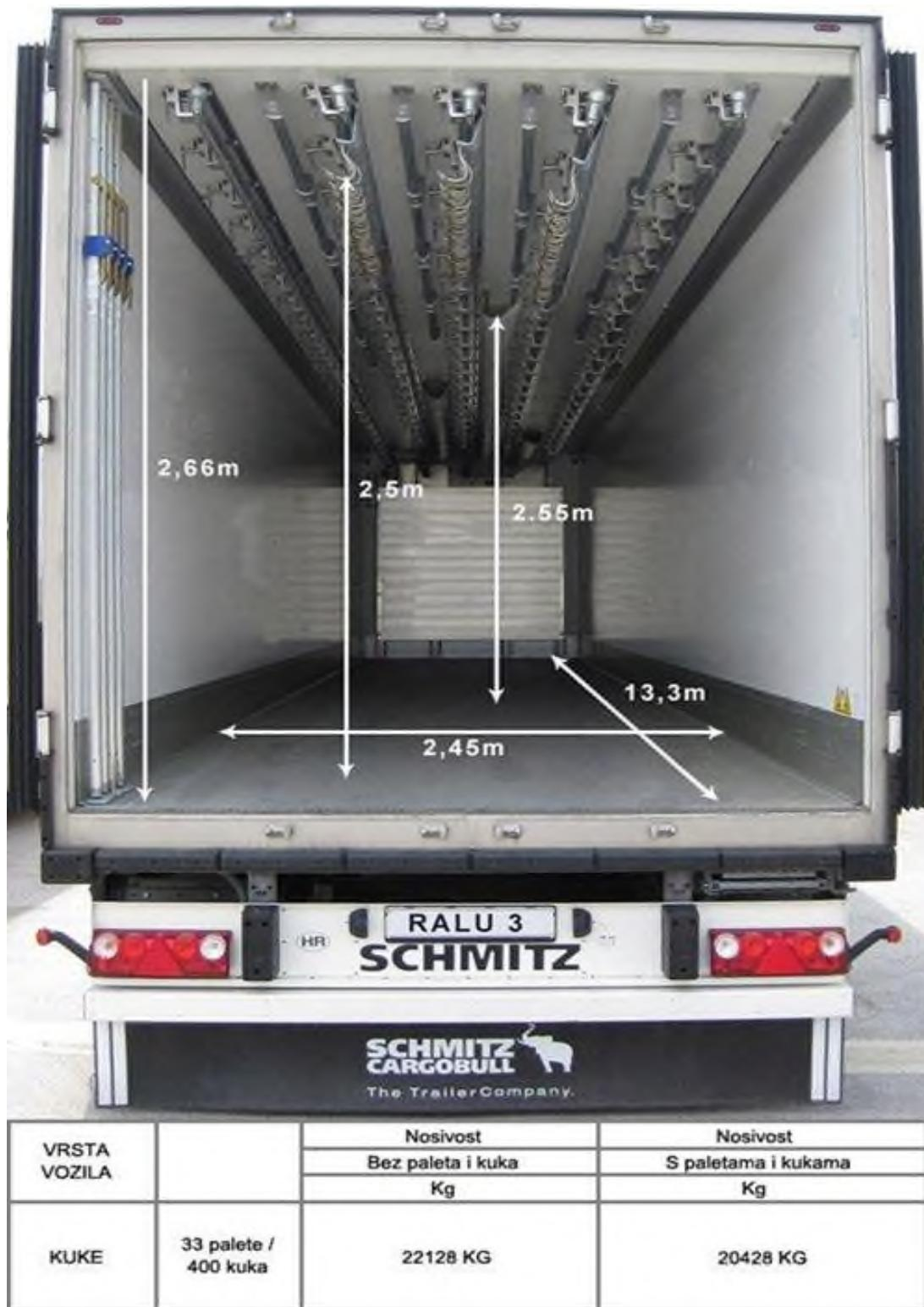
Slika 12. Kamion s rashladnim uređajem – za prijevoz mesa na kukama
