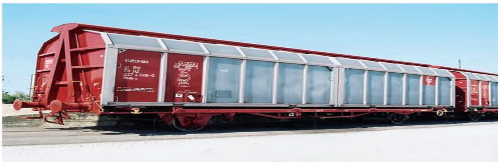
Slika 35. Vagon serije Hbills -z i vagon serije Hbis -z Izvor: ( http://www.hzcargo.hr/serije_vagona.php?page=1 )
