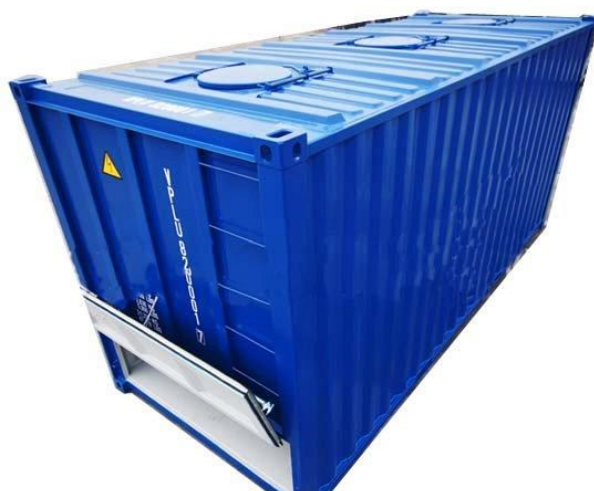
Slika 20. Kontejner za prijevoz rasutih tereta
