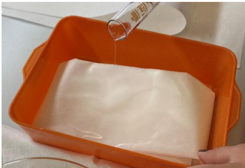
Slika 1. Vlaženje filter papira s destiliranom vodom (izvor: Kovač M.)
