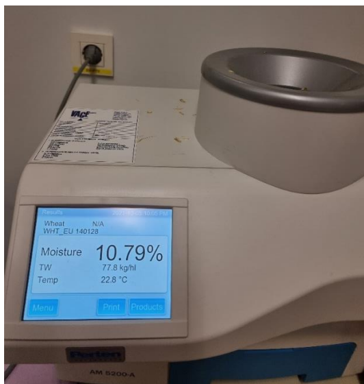
Slika 15. Uređaj za mjerenje vlage i hektolitarske mase (izvor: Mandić M.)
