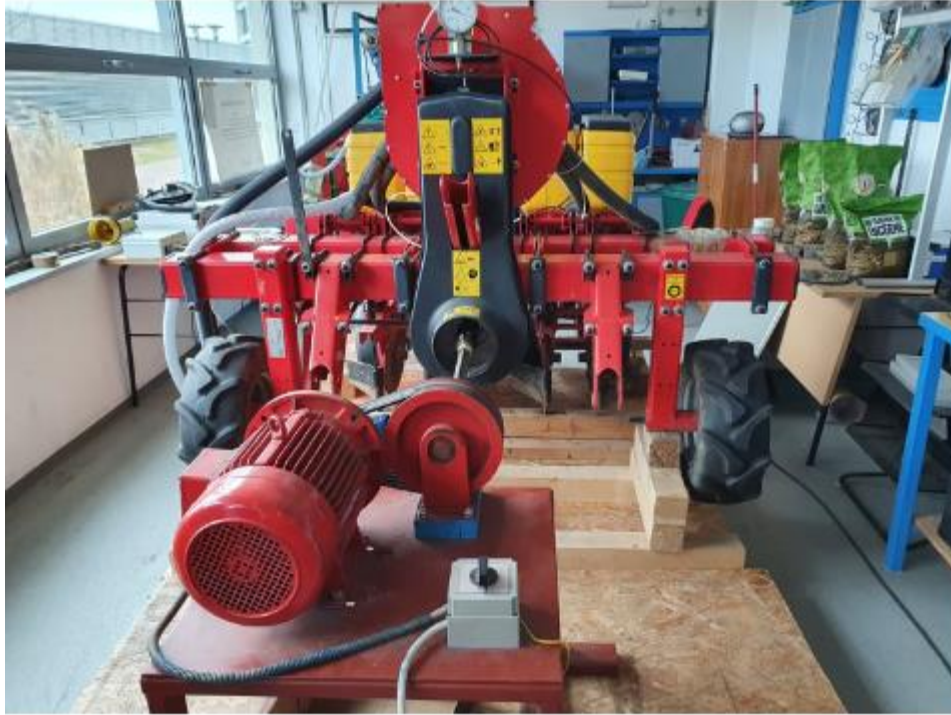
Slika 10. MaterMacc TwinRow sijačica na ispitnom stolu
