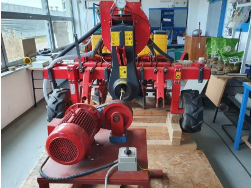
Slika 10. MaterMacc TwinRow sijačica na ispitnom stolu
