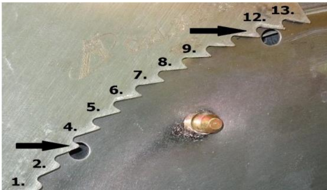
Slika 9. Skidač sjemena kod sijačice MaterMacc Twin Row-2
