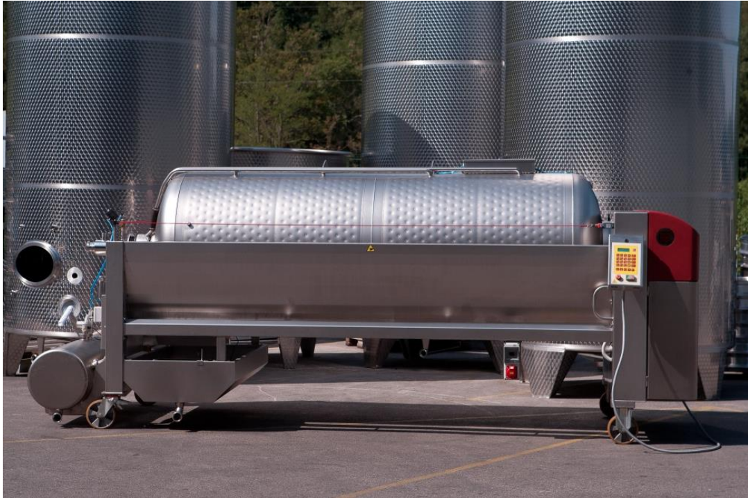
Slika 38. Pneumatska preša za grožđe (Izvor: Vlastita fotografija )
