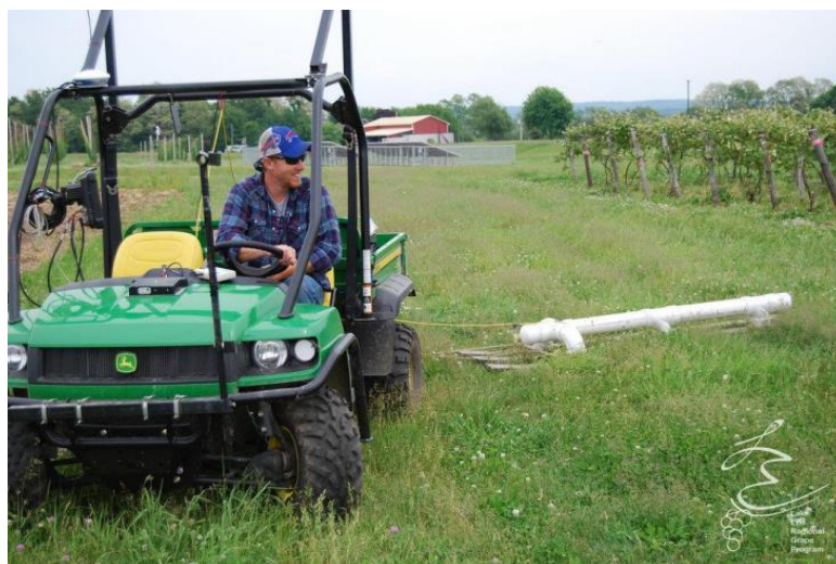
Slika 16. Mjerenje električne vodljivosti tla vinograda
