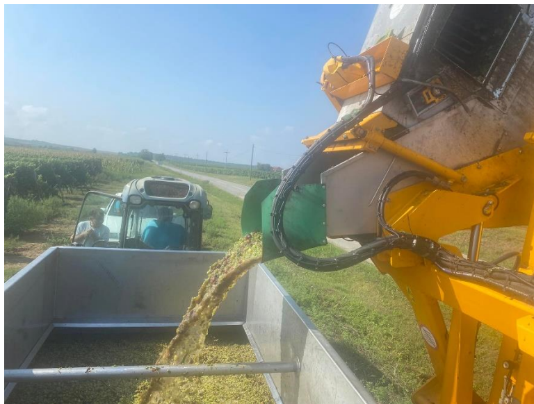
Slika 29. Prikaz pražnjenja grožđa u traktorsku prikolicu
