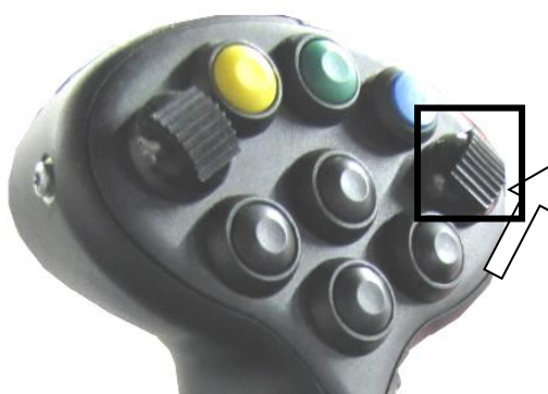
Slika 28. Tipka i smjer za početak pražnjenja spremnika
