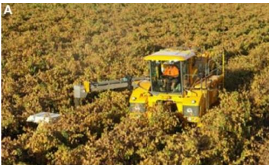
Slika 17.a Kombajn opremljen sa sustavom za praćenje prinosa (Izvor: Matese i Di Gennaro, 2015.)
