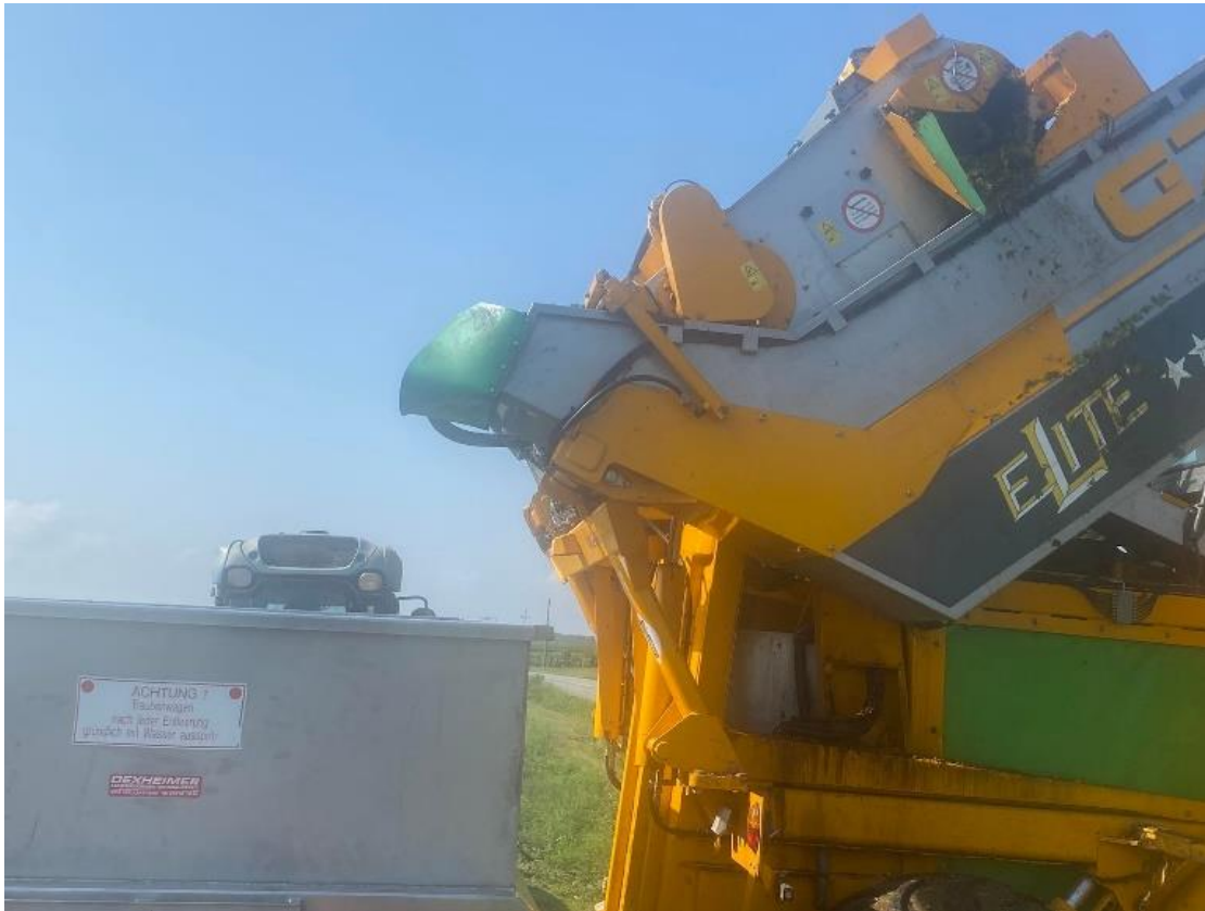
Slika 9. Pražnjenje spremnika za grožđe (Izvor: Vlastita fotografija)
