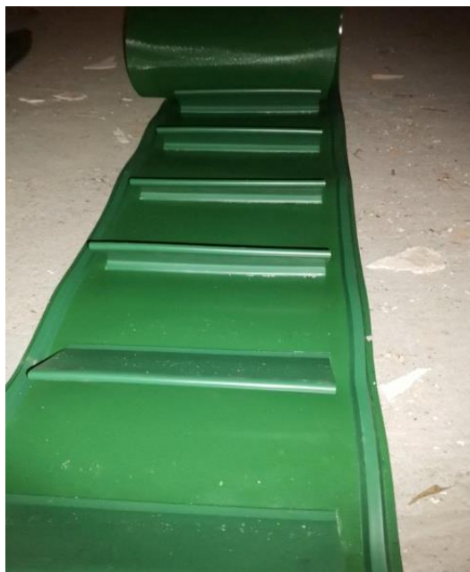
Slika 8. Nemontirana transportna traka
