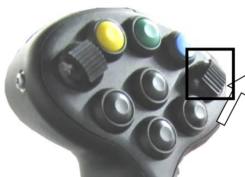
Slika 28. Tipka i smjer za početak pražnjenja spremnika
