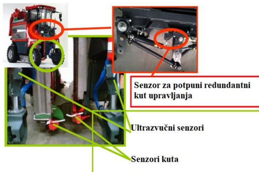
Slika 19. Senzori automatskog upravljanja
