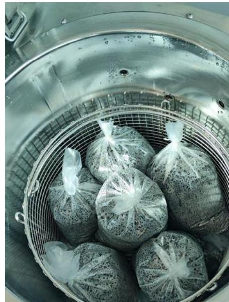
Slika 5. Tuttnauer sterilizator tla (Varga, I.)
