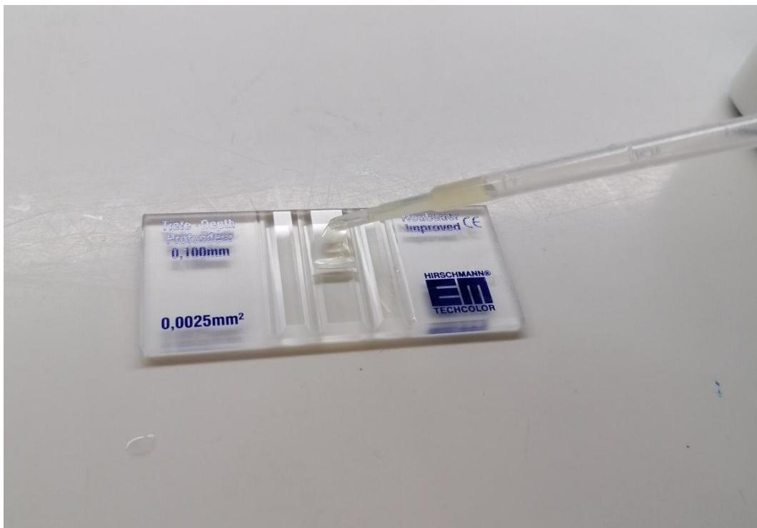
Slika 15. Priprema preparata za mikroskopiranje
