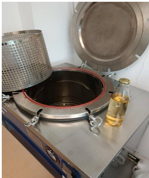
Slika 3. Autoklav korišten za sterilizaciju boca u kojima se pripremaju hranjive podloge (Izvor: I. Rastija)
