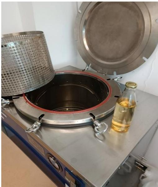
Slika 3. Autoklav korišten za sterilizaciju boca u kojima se pripremaju hranjive podloge
