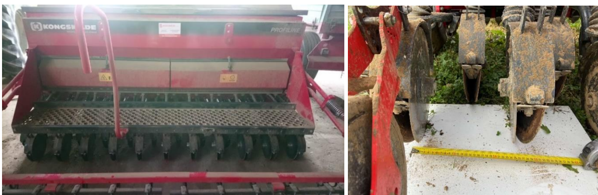
Slika 2.36. a) Žitna sijačica Kongskilde Profiline DR23 ; b) Mjerenje podešenja sijačice (izvor: vlastite fotografije)
