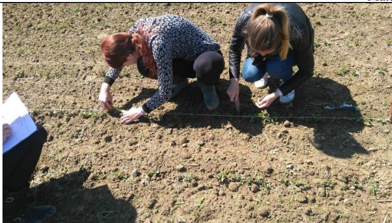
Slika 2.22. Poprečna raspodjela sjemena (izvor: vlastita fotografija)
