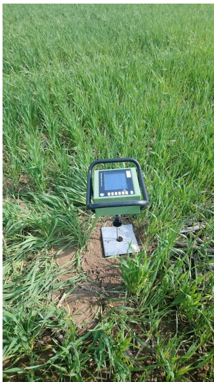
Slika 2.34. Utvrđivanje zbijenosti tla penetrometrom (izvor: vlastita fotografija)
