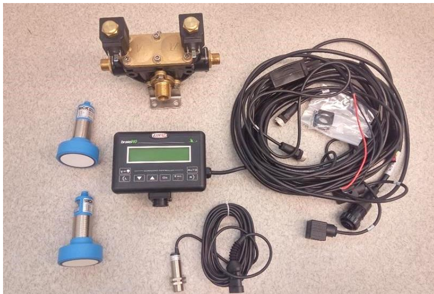
Slika 5. Sustav ultrazvučnih senzora
