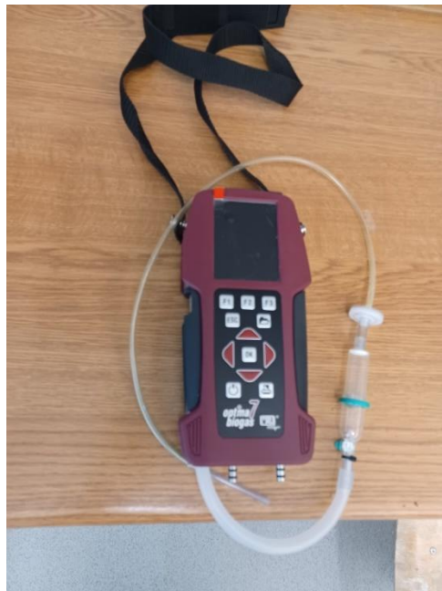
Slika 7. Prijenosni analizator bioplina Optima 7 biogas (Izvor: Autor)
