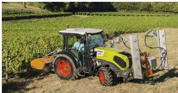
Slika 6: traktor obavlja više operacija u jednom proходу
