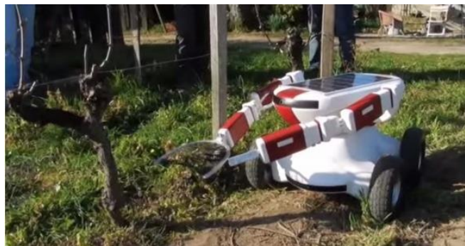
Slika 4: robot za rezidbu vinove loze
