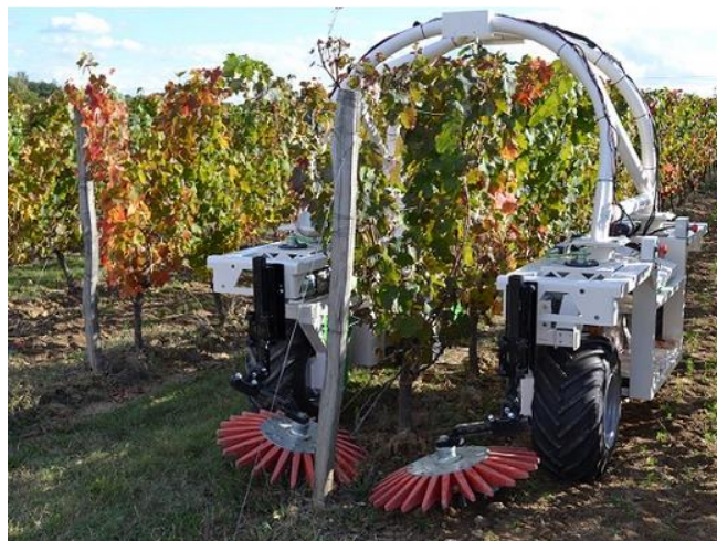
Slika 5: robot čisti unutar reda
