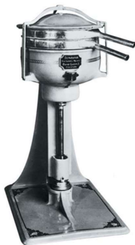
Slika 5. Jedan od prvih separatora, Alfa A 1, proizvodio se od 1882. godine
