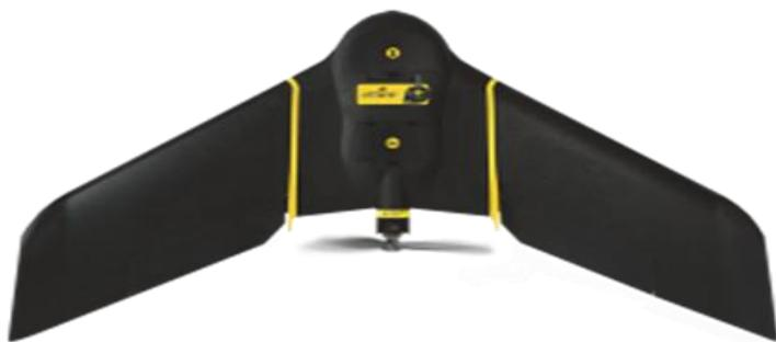
Slika 4. Bespilotna letjelica *eBee Plus*
