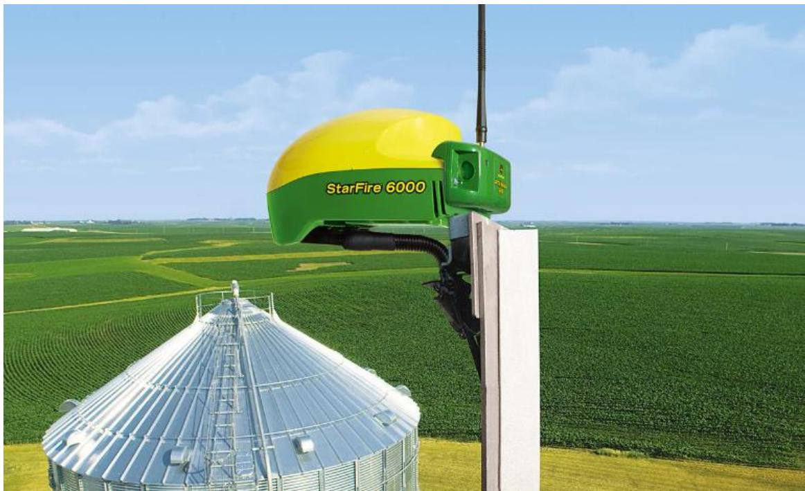
Slika 2. Mobilni RTK modem
