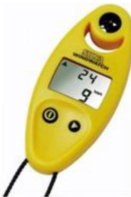
Slika 5. Anemometar Silva WindWATCH
