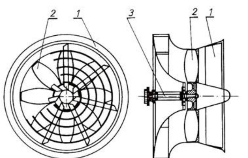
Slika 1. Aksijalni ventilator (1 – kućište, 2 – lopatice, 3 – vratilo) [2]
