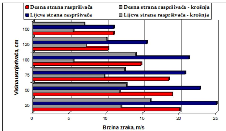
Grafikon 2. Vertikalna distribucija brzine zraka (*Hardi Zaturn* – nasad jabuke)
