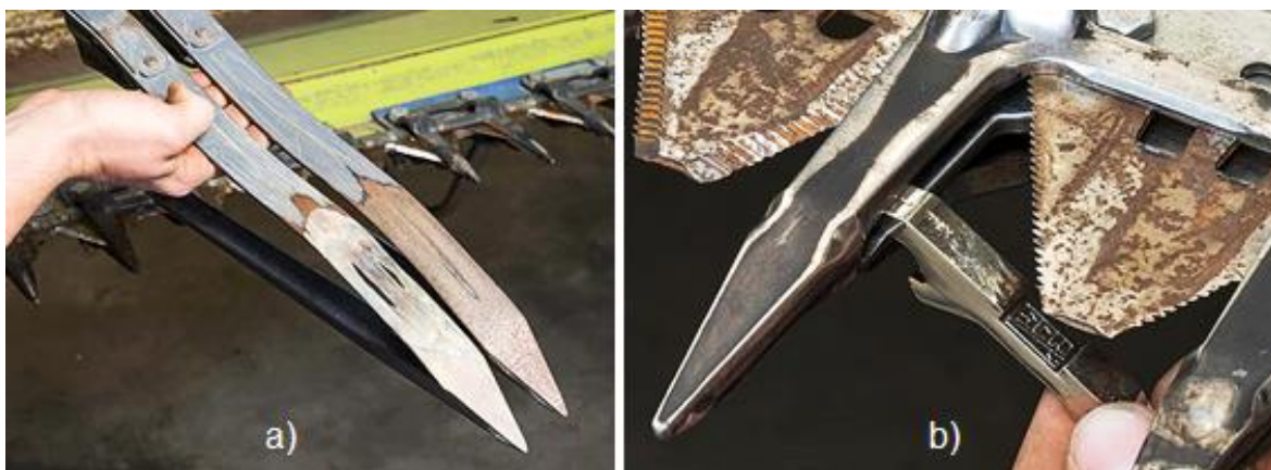
Slika 18. Trošenje razdjeljivača (a), noževa i prstiju kose (b) (Izvor: Bertling, 2022.)
